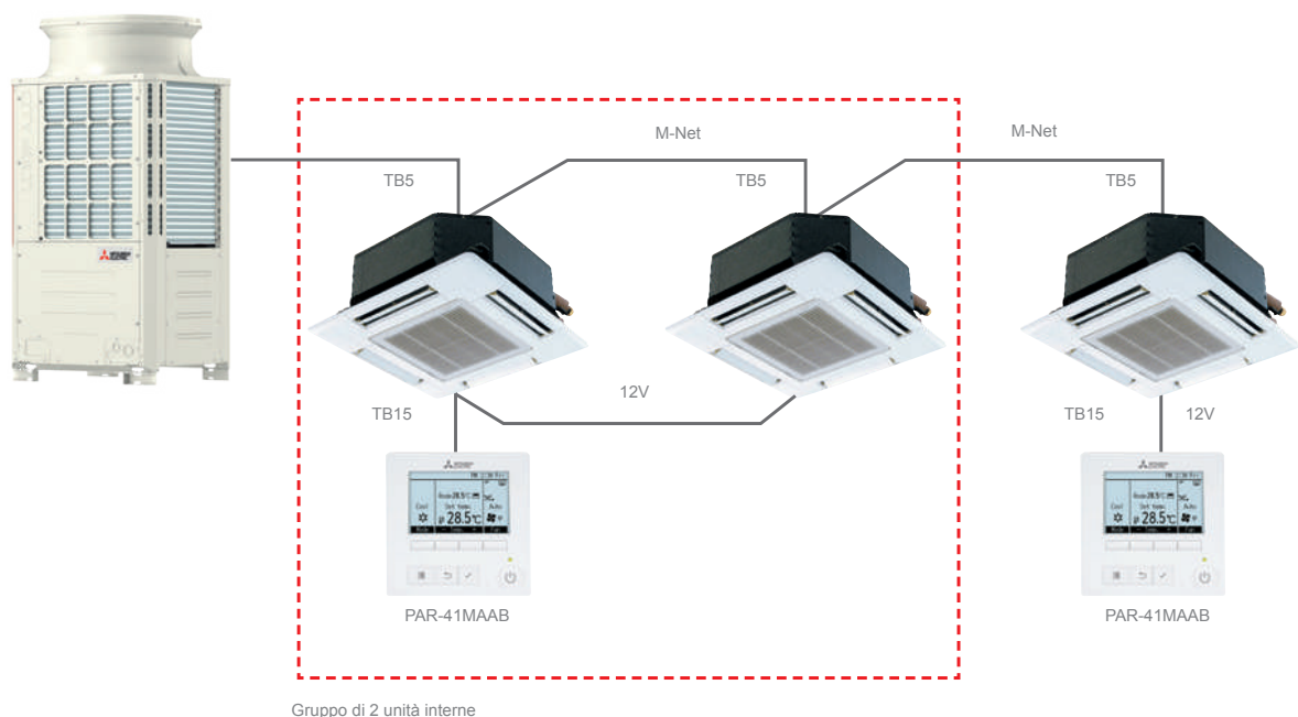
ESEMPIO COLLEGAMENTO COMANDO A FILO (TIPOLOGIA MA)
